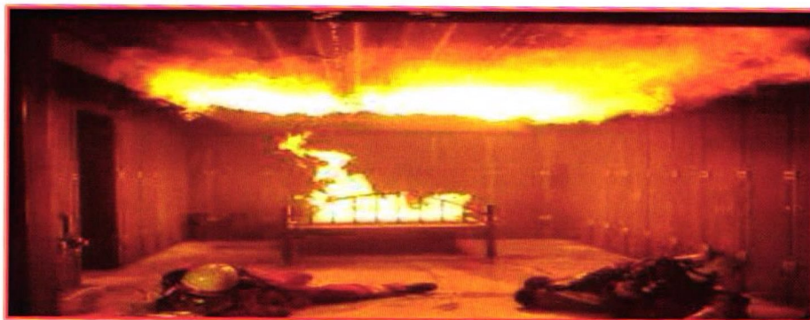
Figura 1. Fase flashover, el ambiente pasa rápidamente de un incendio en crecimiento a una afectación total de la habitación, provocando una combustión súbita generalizada.
