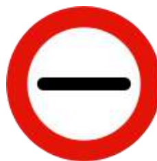
R-200 Prohibición de pasar sin detenerse
