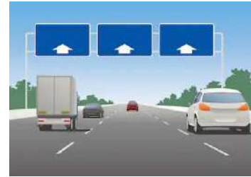
Marca longitudinal discontinua (de separación carriles)
