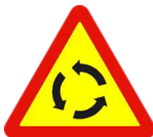
TP-4 Intersección con circulación giratoria
