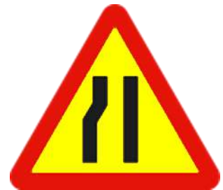
TP-17b Estrechamiento de calzada por la izquierda
